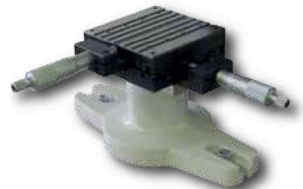
Manual Table area 100 x 100 mm, range 25x25 mm, div. 0,01 mm.
